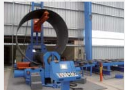
Lateral arm with double articulation and hydraulic manipulators Braccio laterale con doppia articolazione e manipolatori idraulici
