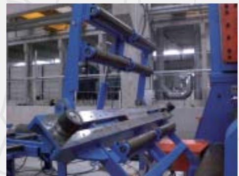
Lateral arm with double articulation and hydraulic manipulators Braccio laterale con doppia articolazione e manipolatori idraulici
