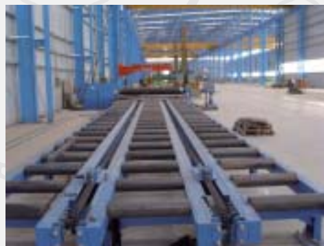
Motorized plate conveyor Vie rulli motorizzate per inserimento lamiera
