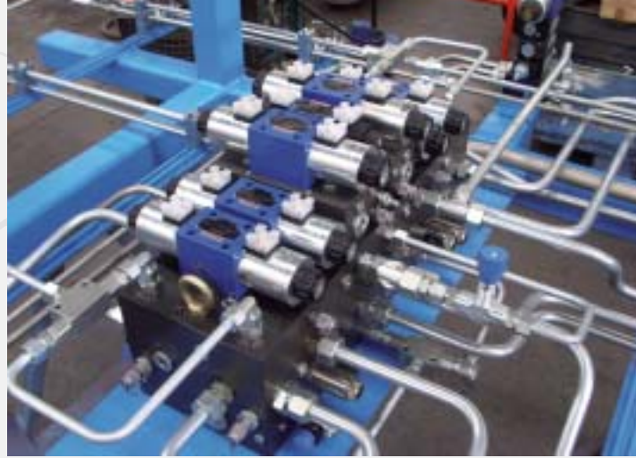
Hydraulic unit with one block and hoses Impianto idraulico con massello monoblocco e tuberia rigida.
